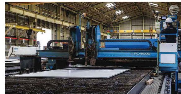
プラズマ切断機
